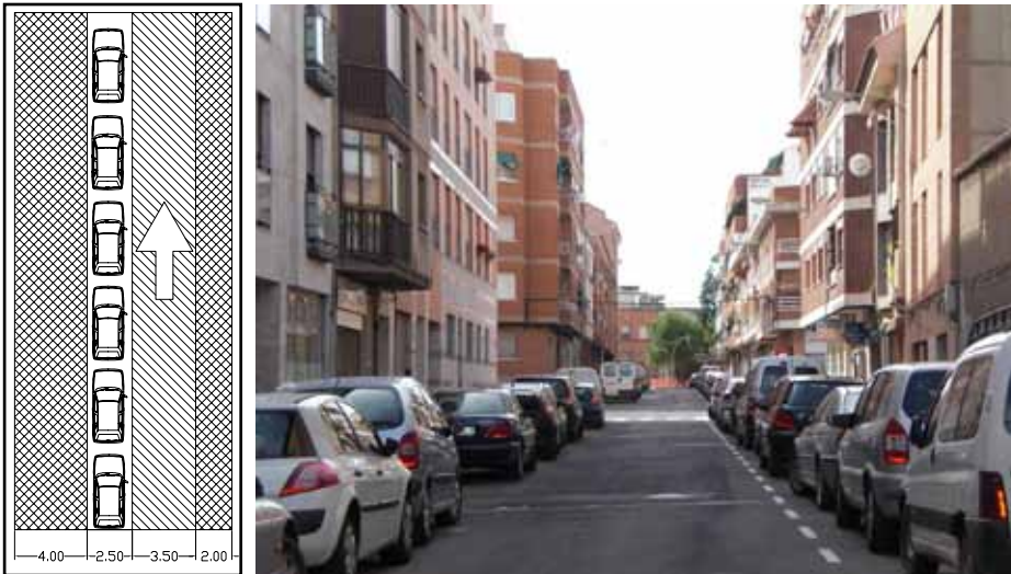
Figura 6.107.- Tipo 5. Conexión interna sin vegetación y una dirección. Calle del Carmen
